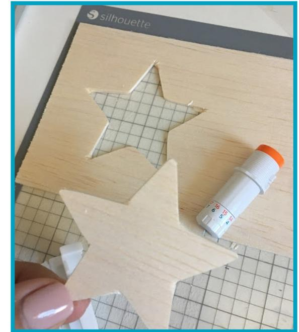
Indicada para cortar materiales de hasta 3 mm de grosor: acetato, madera de balsa, foamy, cuero, entre otros.
